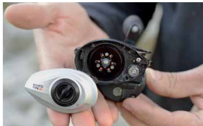
Standardna centrifugalna zavora. Črn gumb na srebrnem pokrovčku je magnetna zavora.
