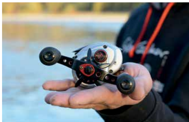
Črn gumb na srebrnem ohišju zgoraj je gumb, ki ustvari trenje ( angl. tension knob). Vidna je tudi zvezdasta zavora; z njo nastavimo, kako močno lahko riba izvleče vrvice.
