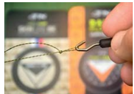
Zanko utrdite s pripravo za zategovanje vozlov. Pri tem uporabite primerno silo. Odvečno vrvico odrežite s škarijami za rezanje pletene vrvice.
