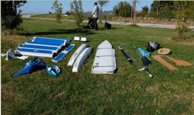
Sestavni deli čolna ORIGO. Natančna izdelava omogoča sestavljanje v 10–15 minutah, za kar ne potrebujemo nobenega orodja.
