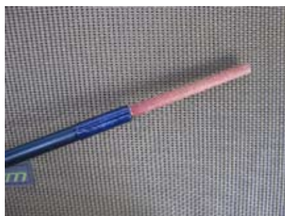
Še isto popoldne sem doma takole popravil zlomljen zgornji del na srednjem delu palice. Ker ni bilo mogoče več drugače, sem v blank vgradil t.i. trn, na katerega se nasadi zgornji del palice. Upam, da bo služilo namenu.
