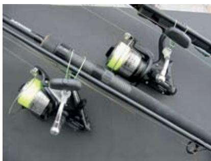
Shimano baitrunner 4000 OC; moje nove lepote bo treba še preskusiti. Štirje nerjavni ležaji, aluminijasta tuljava, moč zavore 7 kg itn.
