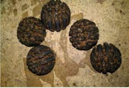
Slika 3: Nosilci bakterij iz statičnega biofiltra pred izpihovanjem. Nosilci bakterij opravljajo hkrati biološko filtracijo in mehansko filtracijo; mehanski delci se med kroženjem vode ujamejo na površini nosilcev bakterij, potrebno je občasno izpihovanje.
